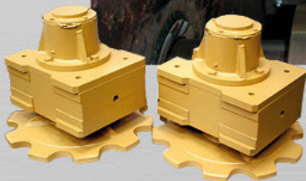
Couronne et paliers séchoir (briqueterie)
